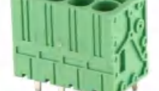
Pitch:7.5mm 可提供带错位针脚的型号 JL271V UL:600V/40A 24-8AWG IEC:1000V/41A 6.0mm² Poles:1-24P
