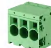
Pitch:10.0mm 可提供带错位针脚的型号 JL271R UL:300V/66A 18-4AWG IEC:630V/76A 16.0mm² Poles:1-24P
